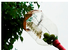
← ペットボトル内のワイヤーに枝を絡めて梅を収穫、脚立不使用でも収穫ができます。
